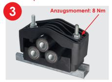
Muttern mit einem geeigneten Drehmomentschlüssel nur bis zum angegebenen Anzugsmoment wechselseitig anziehen. Keine selbstsichernden/-hemmenden Muttern verwenden, ein definiertes Anzugsmoment ist sonst nicht möglich.
